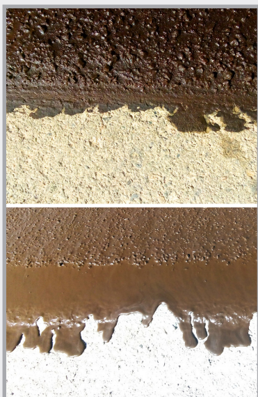
قیرامولسیون زودشکن در کمتر از ۳۰ دقیقه خشک می شود
