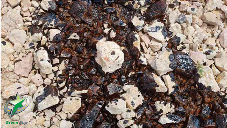
قیر امولسیون ۰۴ درصد کاتیونیک با ۴ کیلوگرم امولسیفایر روی سطح بیس آہکی / کوہی با بار مثبت
