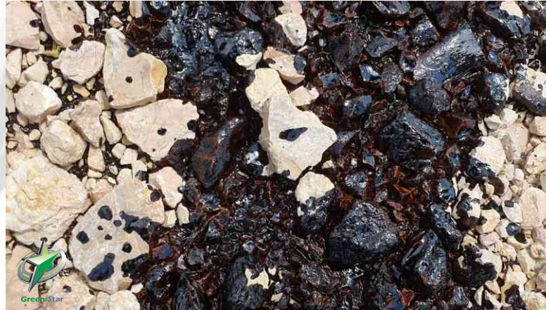
قیر امولسیون ۰۵ درصد کاتیونیک با ۴ کیلوگرم امولسیفایر روی سطح بیس آہکی / کوہی با بار مثبت
