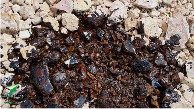
قیر امولسیون ۰۴ درصد کاتیونیک با ۴ کیلوگرم امولسیفایر روی سطح بیس آہکی / کوہی با بار مثبت
