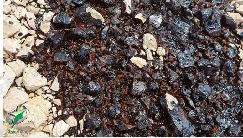
قیر امولسیون ۰۵ درصد کاتیونیک با ۴ کیلوگرم امولسیفایر روی سطح بیس آہکی / کوہی با بار مثبت
